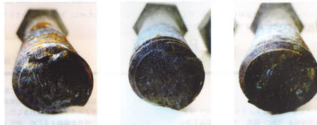
写真-2 ボルト破断面
